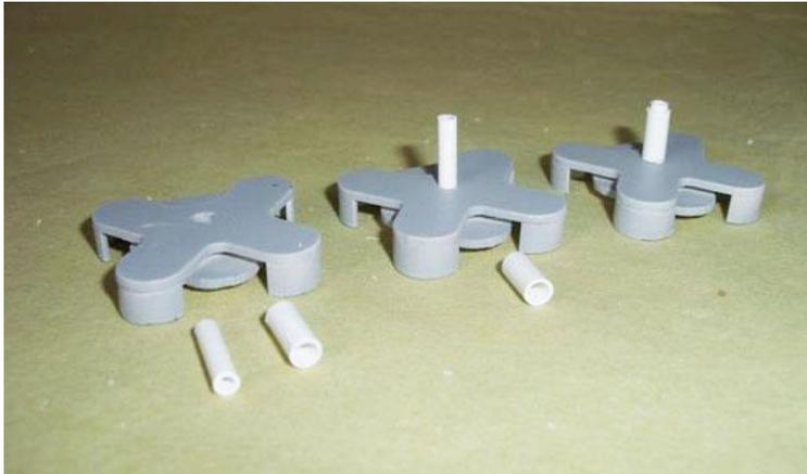
An die Unterseite steckt das Innenrohr etwa 1.5 mm aus das Aussenrohr für die verklebung in die Bodenplatte.
